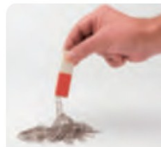
② El imán ejerce sobre los clips una fuerza de atracción a distancia.
